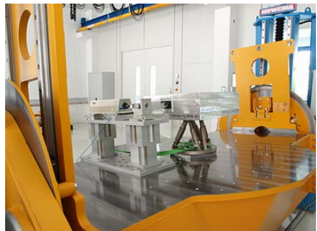
Fig. 5 Am Standort in Karlsruhe dient eine Hub- und Kippvorrichtung der spezifisch an die Applikation angepassten Vermessung bzw. dem Qualifizieren von Produkten. Hier wird ein Hexapod mit Last interferometrisch vermessen.
