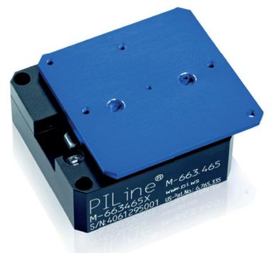
Der M-663 PLine® Mikropositioniertisch erreicht Geschwindigkeiten von mehreren 100 mm/s und Stellwege von mehreren 10 mm. Mit 15 mm Höhe, 30 mm Breite und 35 mm Tiefe lässt er sich gut in die jeweilige Anwendung integrieren
